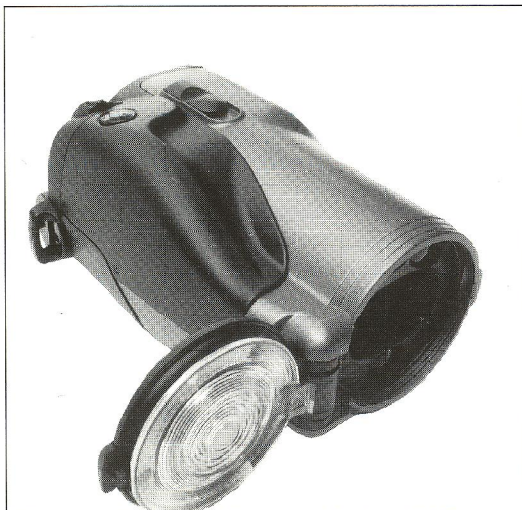
Samtidigt med, at der zoomes, flyttes fresnell skiven foran flashen frem og tilbage, sådan at lysvinklen justeres. Her ses henholdsvis 35 og 105 mm indstilling.
